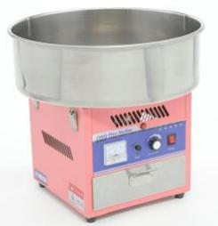
**FABRICADORA DE ALGODONES DE AZÚCAR MARCA MIGSA.** FABRICADORA CON CAPACIDAD DE 4 A 6 ALGODONES POR MINUTO, FABRICADO EL GABINETE EN LÁMINA ESMALTADA Y EL TAZÓN EN ACERO INOXIDABLE, CAJÓN CON MEDIDOR Y DIVISIONES PARA EL AZÚCAR, POTENCIA DE RESISTENCIA DE 950 WATTS Y EL MOTOR DE 80 WATTS A 120 VOLTS, 60 CICLOS, PESO BRUTO 14.5 KGS., PESO NETO 13 KGS.
