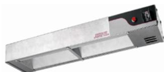
LÁMPARAS REFLECTORAS DE CALOR MARCA MIGSA. GABINETE EN ACERO INOXIDABLE RESISTENTE A LA CORROSIÓN DE FÁCIL LIMPIEZA Y ATRACTIVO DISEÑO, PARA FIJAR A TECHO O PARED, RESISTENCIA CALEFACTORA DE 0.5 KW A 110-120V, TERMOSTATO PARA AJUSTE DE TEMPERATURA IDEAL PARA ESTACIONES DE SERVICIO PARA MANTENER LA COMIDA CALIENTE. PESO NETO DE 3 KGS. MEDIDAS: 615 X 155 X 65 MM. | CÓDIGO SAT / 39101613
