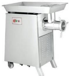
**MOLINO DE CARNES DE 5 H.P. CABEZAL DE ACERO INOXIDABLE MARCA MIGSA.** FABRICADO EL CUERPO EN ACERO INOXIDABLE. CABEZAL DE ACERO INOXIDABLE DEL NO. 42 CON CHAROLA. CAPACIDAD DE MOLIENDA DE HASTA 650 KGS POR HORA. POTENCIA DEL MOTOR DE 4,000 WATTS (5 H.P.) A 220V / 60HZ / 3F (TRIFÁSICO). TRANSMISIÓN DE BANDA Y CADENA DE ALTA RESISTENCIA. EQUIPADO CON NAVAJA Y CEDAZO DE 6 MM. INCLUYE REPUESTO DE NAVAJA Y CEDAZO DE 8 MM. PESO NETO DE 187 KG.
