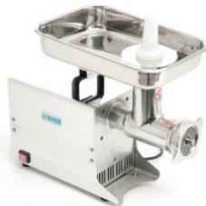
**MOLINO DE CARNE COMERCIAL 1H.P. MARCA MIGSA,** FABRICADO EL CUERPO EN ACERO INOXIDABLE TIPO 304., CABEZAL EN FUNDICIÓN DE ACERO INOXIDABLE DEL No. 22, MOTOR DE 750 W (1 H.P.) A 110 V/60 CICLOS, BOTÓN DE ENCENDIDO Y APAGADO, PESO BRUTO 25.5 KGS. PESO NETO 23 KGS.
