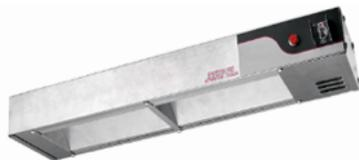
LÁMPARAS REFLECTORAS DE CALOR MARCA MIGSA. GABINETE EN ACERO INOXIDABLE RESISTENTE A LA CORROSIÓN DE FÁCIL LIMPIEZA Y ATRACTIVO DISEÑO, PARA FIJAR A TECHO O PARED, RESISTENCIA CALEFACTORA DE 1.2 KW A 110-120 VOLTS, TERMOSTATO PARA AJUSTE DE TEMPERATURA IDEAL PARA ESTACIONES DE SERVICIO PARA MANTENER LA COMIDA CALIENTE, PESO NETO DE 5 KGS. MEDIDAS: 1220 X 155 X 65 MM. | CÓDIGO SAT / 39101613
